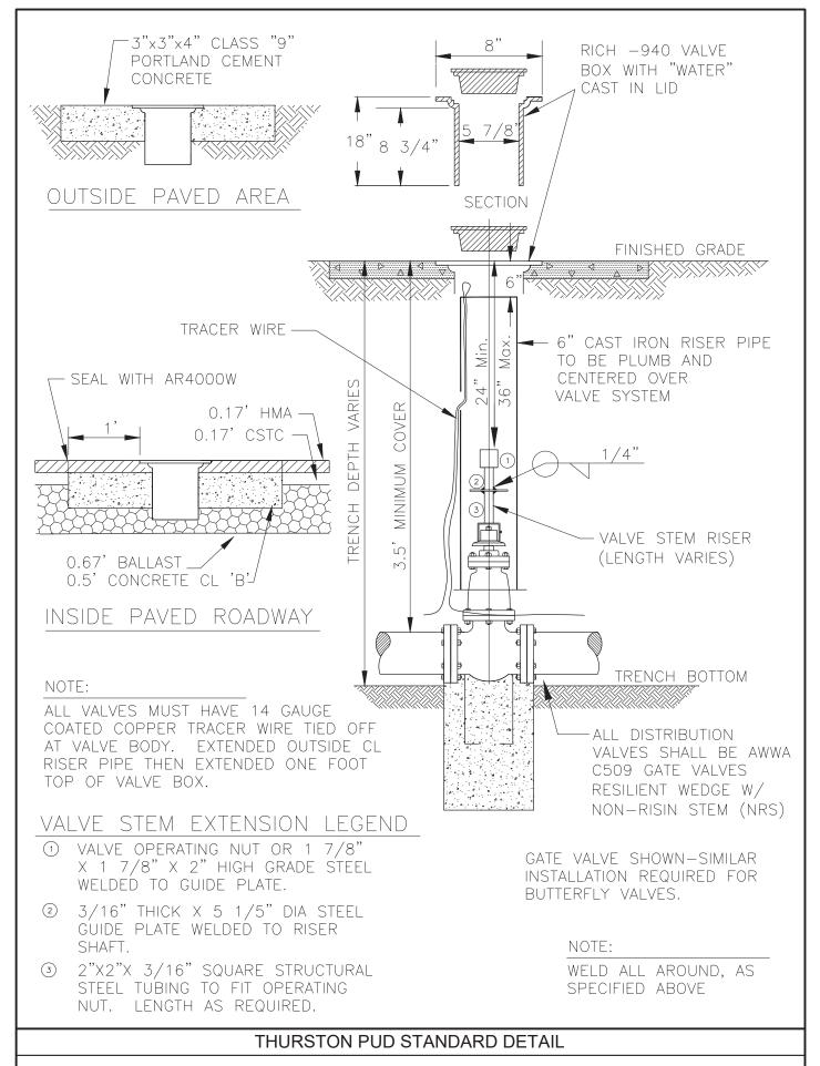
FIGURE 5 - DISTRIBUTION SYSTEM VALVE ASSEMBLY
